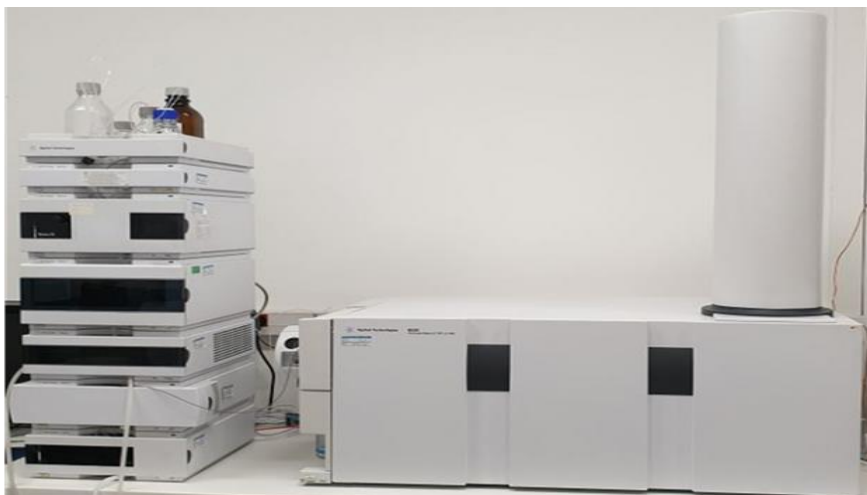
Slika 15. LC uređaj 1290 infinity II (Agilent Technologies) spojen na detektor Agilent 6550 iFunnel Q-TOF koji se nalazi u metabolomskoj jedinici na Institutu Ruđer Bošković.
