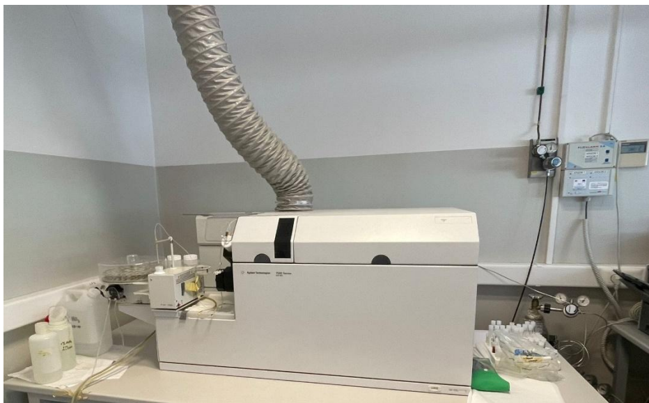
Slika 12. Uređaj ICP-MS (vlastita fotografija).
