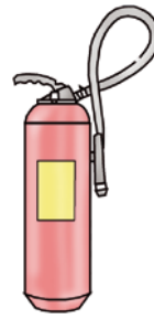
Sl.32. Aparat pod stalnim tlakom za početno gašenje požara prahom. Dijelovi aparata jesu spremnik, ručica za aktiviranje, osigurač, crijevo i mlaznica te često manometar. Na aparatu se mora nalaziti naljepnica s rokom uporabe. Najmanje jednom godišnje aparat provjerava ovlaštena pravna osoba. Spremnik je pod stalnim tlakom od cca 15 bara.
